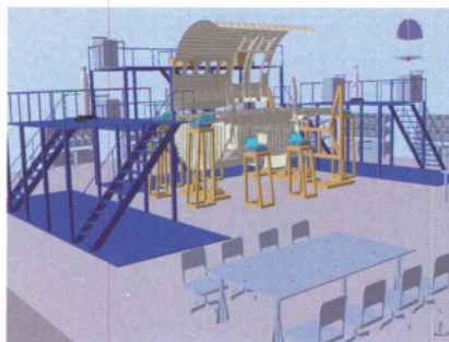
图3 装配流程的仿真分析
